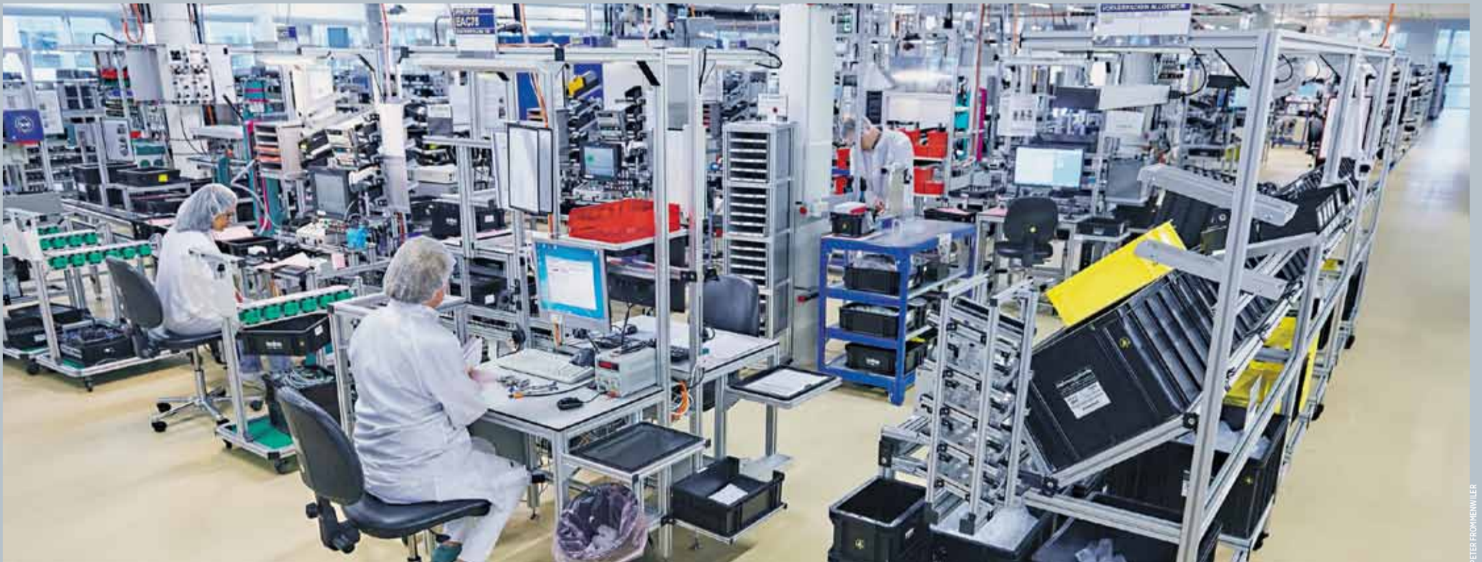
Fabrikation: Die Drucksensoren von Trafag werden in Einzelflussfertigung in der modernen Hightech-Anlage unter Reinraum-Bedingungen hergestellt.
